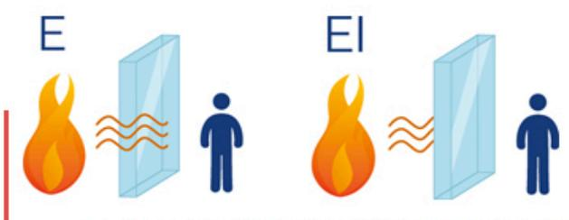
Os vidros antifogo da classe E (Integridade) oferecem resistência à passagem de chamas e fumaça, durante um determinado período. Já os antifogo da classe EI (Integridade e Isolamento), além de oferecer resistência à passagem de chamas e fumaça, impedem a transmissão de calor por um determinado período.
